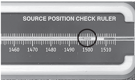
図 6 線源停止位置の確認
