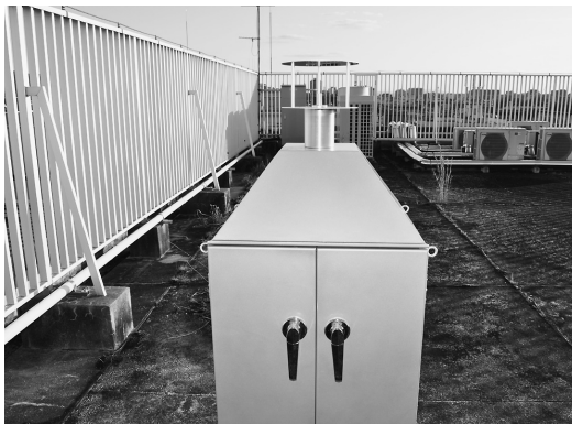
図2 本学学生部棟屋上に設置してあるリアルタイム花粉モニター(KH-3000)
