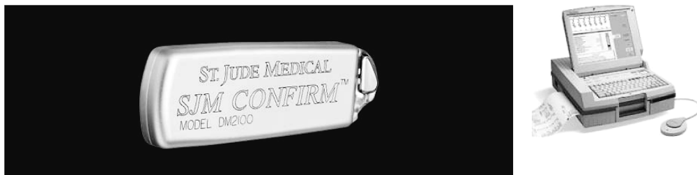
図1 Implantable loop recorder の外観とプログラマ 現在日本で使用可能な2機種を示す。
