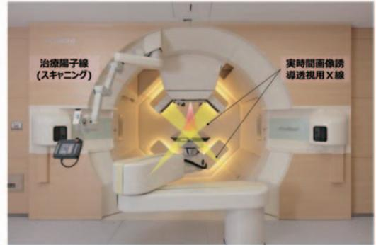
図2 実時間画像誘導スポットスキャニング陽子線治療装置 (Real-time-image Gated Proton beam Therapy system)
