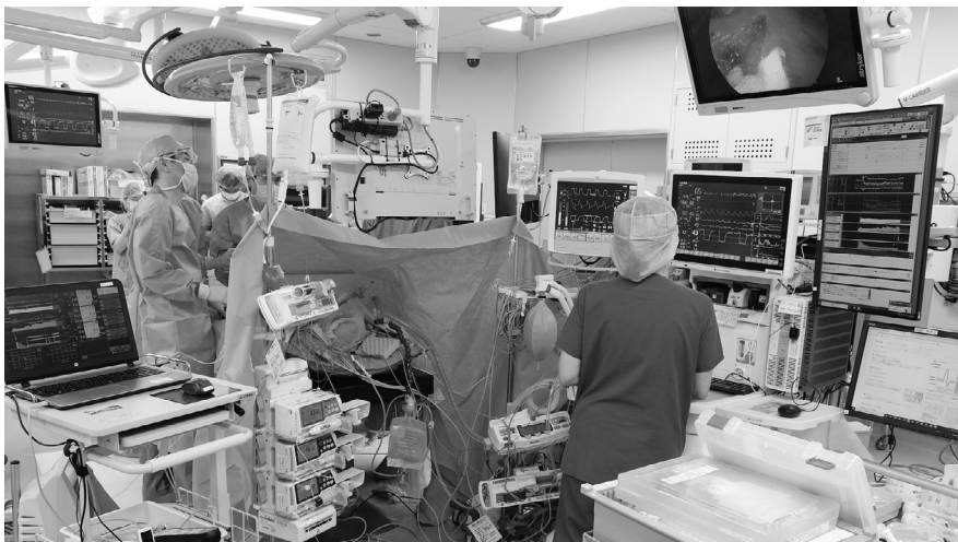
図4 ロボット麻酔システムの構成（移動型の写真）
