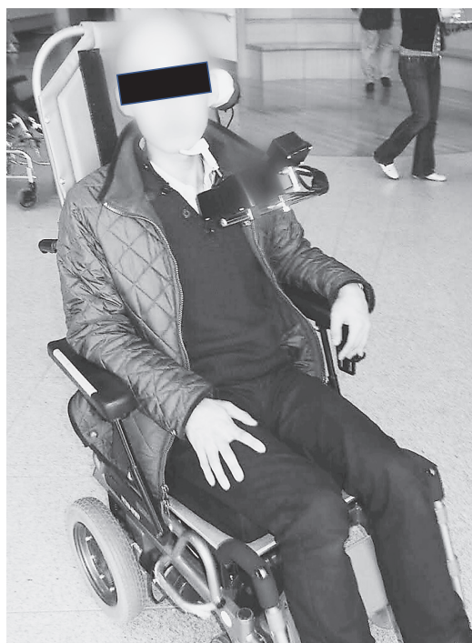
図3 四肢麻痺でも操作できる顎でコントロールする電動車いす
