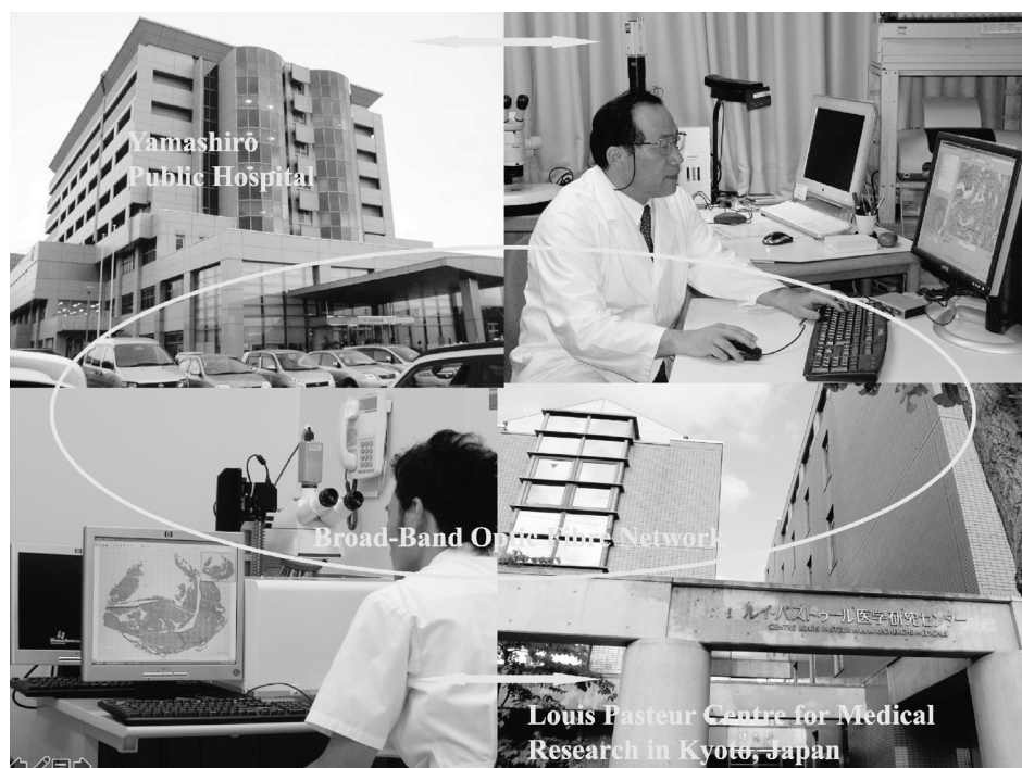
図6 山城医療センターの病理検査室と公益財団法人ルイ・パストゥール医学研究センターをB-band光ファイバーで結ぶWSI (Whole Slide Imaging) によるテレパソロジーシステム。左下は標本作製と機器操作にあたる山城病院の橋本行正技師長，右上は遠隔診断中の筆者。
