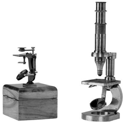
図2 19世紀に製造された Carl Zeiss 社の顕微鏡。(左) 1848年まで製造されていた解剖顕微鏡。(右) 現存する最古の複式顕微鏡の1つ。1862年製造。From the Timo Mappes; photographed by Manfred Stich (ZEISS Archives).
